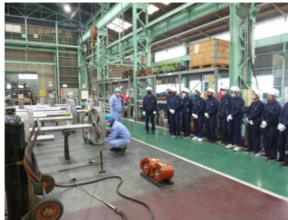
シャフトにギアを通す“焼きはめ”②(クレーンを使った加工)
