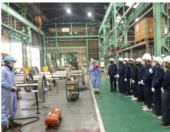
シャフトにギアを通す“焼きはめ”①(パーナーによる焼き)
