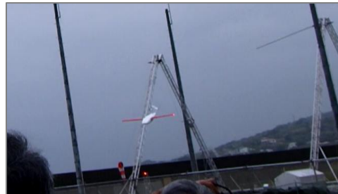
ドローン回収 ※支柱に張られたロープに引っかけて 機体を回収
