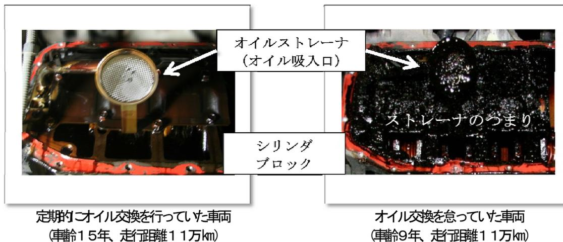
図1 使用過程車のエンジン内部の比較
