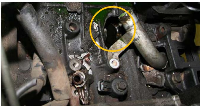
図5 シリンダブロックの貫通孔
