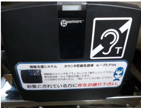
車内に設置された磁気ループ
