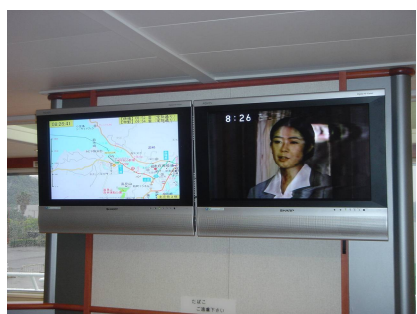
電子地図式運航標示装置 ※モニター画面に現在地が逐次表示される装置
