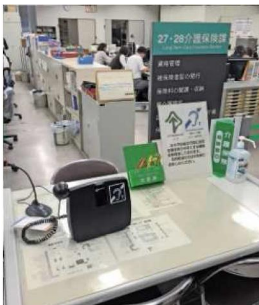
高松市役所に設置されている磁気ループ
