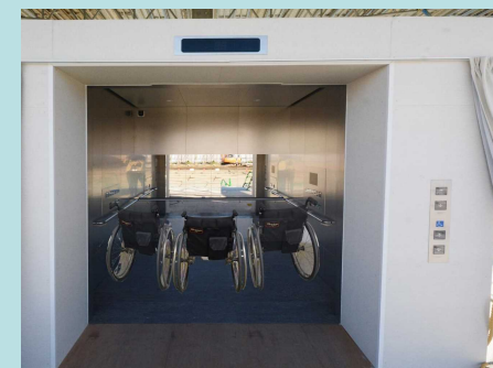
エレベーターの実物大の検証模型
