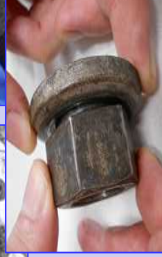
劣化したナットの点検・交換
