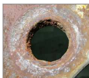
ホイールのボルト穴の損傷
