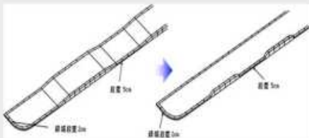
歩道の高さを5cmとし波打ちを解消したイメージ
