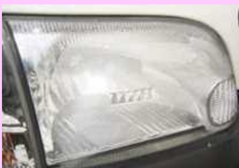
内部リフレクタの劣化
