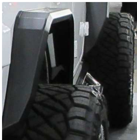
不適合箇所の例（タイヤ・ホイールの突出）
