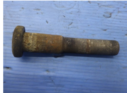
締め付け不良・潤滑剤が塗布されていない
