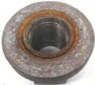
潤滑剤が塗布されていない
