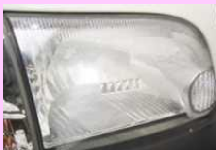
内部リフレクタの劣化
