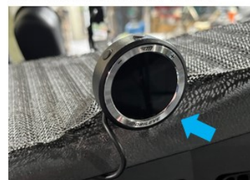
■表示装置取付部分拡大
