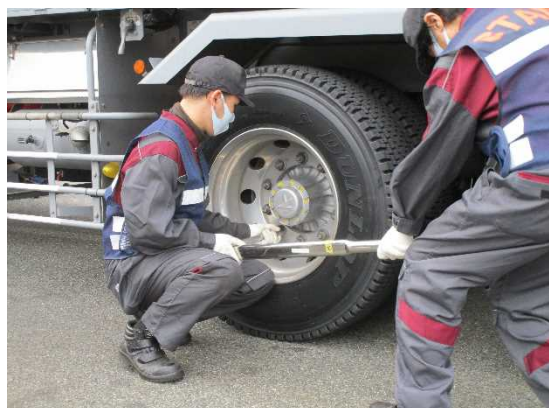
※大型車の車輪脱落の防止等を目的とした街頭点検の様（令和2年度）
