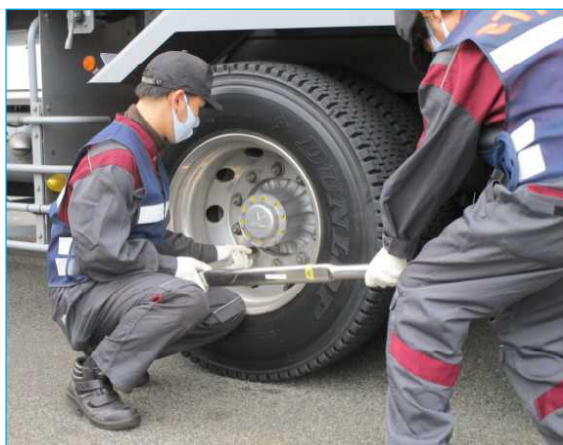
大型車の車輪脱落の防止等を目的とした街頭点検の様子（イメージ）
