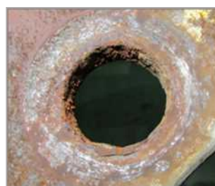
ホイールのボルト穴の損傷
