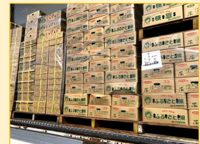
冷蔵庫内との気温差、時間経過 により箱が潰れている様子
