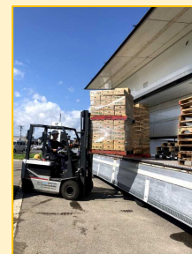
パレットの2段積み の状況
