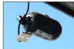
左：動態管理システム用の車載カメラ 右：動態管理システムによるトラックの位置情報
