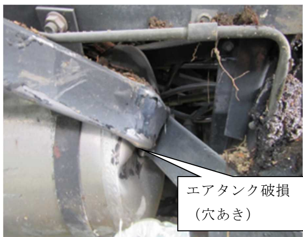
写真5 前輪ブレーキ用右側エアタンク
