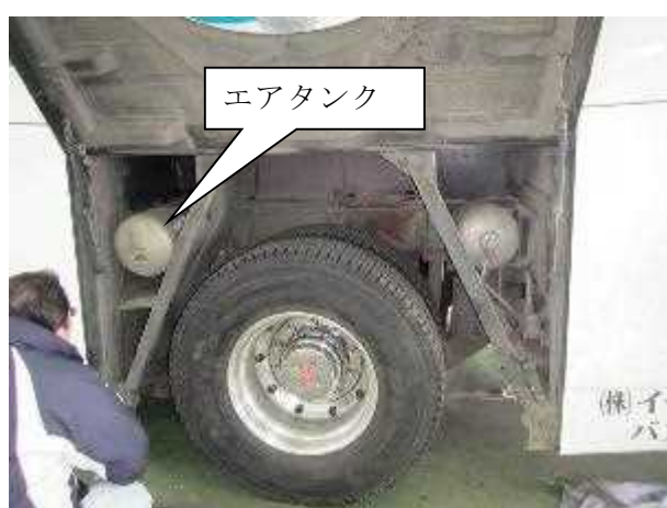
写真6 後輪ブレーキ用左側エアタンク
