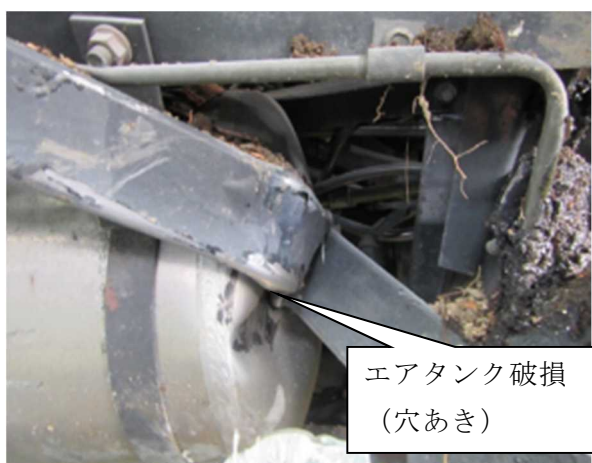
写真5 前輪ブレーキ用右側エアタンク
