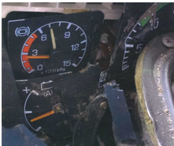
写真7 ブレーキエア圧力メータ
