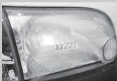
内部リフレクタの劣化
