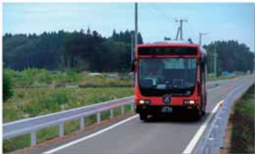
鉄道敷きを舗装して走る BRT H24.8.20
