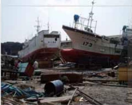
造船所の施設・設備は、地盤沈下や津波により損壊・浸水・流出し、建造途中の船舶は津波により沈没・座礁するなど、甚大な被害が発生した。
