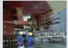
船体とプロペラの外観検査
