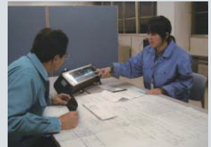
溶接部のX線写真の検査
