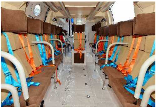
左図：津波救命艇外観 右図：内観
