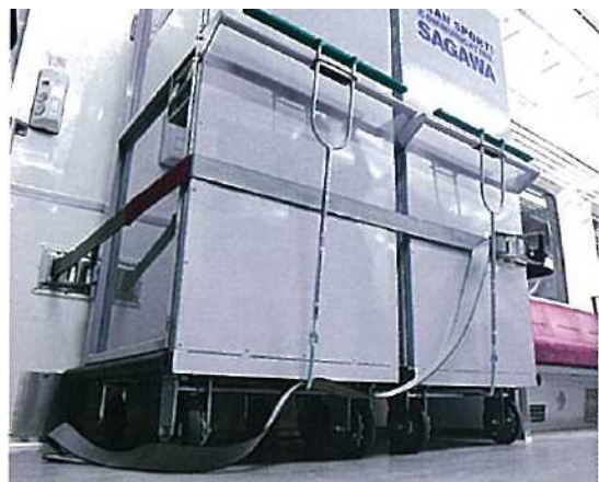
専用のカーゴ台車を用いて車両に固定
