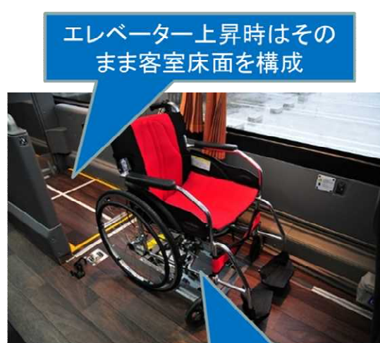
新しいタイプの車椅子固定装置
