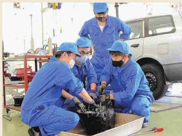
実習で変速機の分解整備を行う秋田技術専門校の2年生
