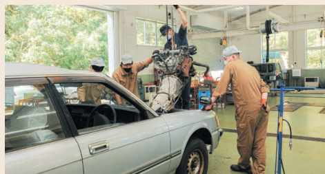
応用実習で、エンジンの取り外し作業を行う2年生
