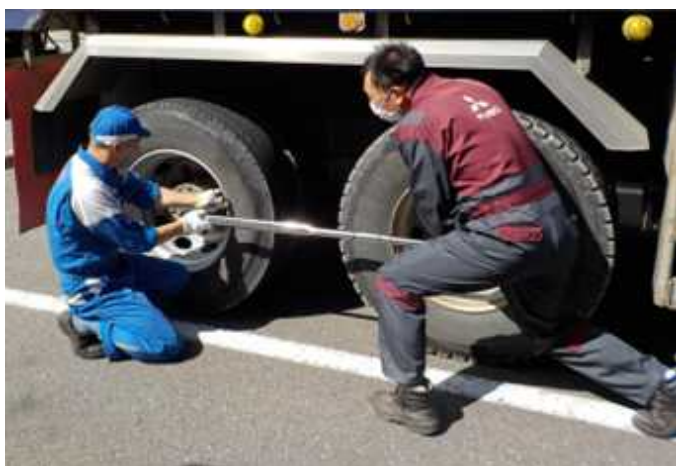
【ホイール・ナット締付状態の確認の様子】
