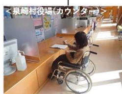
< 泉崎村役場(カウンター) > カウンターの高さは良いが蹴込の奥行きが不足
