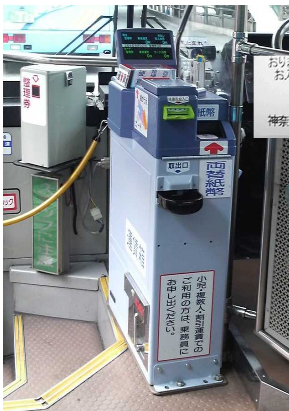
図 2-3 バーコード運賃箱（神奈川中央交通株式会社での導入例）
