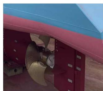
5翼可変ピッチプロペラ、エコキャップ、旋回流回収型舵
