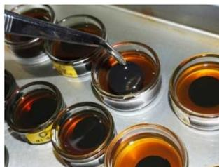
ゴム材料の浸食試験
