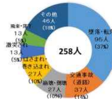
令和2年の建設業における事故の型別内訳(死亡)
