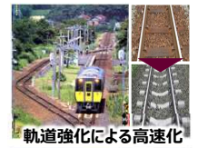
軌道強化による高速化
