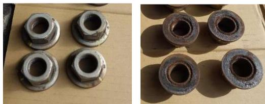
（ホイール・ナット上面からはナット座面の状態が確認できない場合が多く、ワッシャーが固着しているものもある。）
