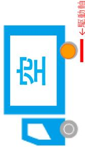
駆動軸に十分な荷重がかからず、発進性能が低下。
