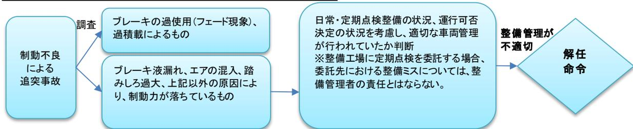
具体的事例3: ブレーキを踏んで停止しようとしたところ、効きが悪く信号待ちの車列に追突。調査を行った結果、日常点検を実施していないことが判明。また、ブレーキの踏みしろが大きかったことが、制動力低下の原因となっていた。→ 解任命令発令基準1. に該当
