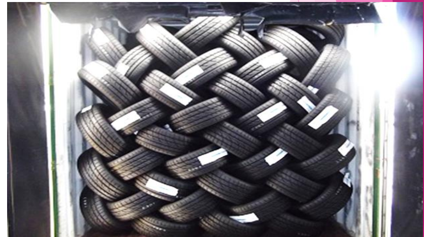
レース積み (タイヤを編み込むように積んでいく。輸出向けの積載方法)
