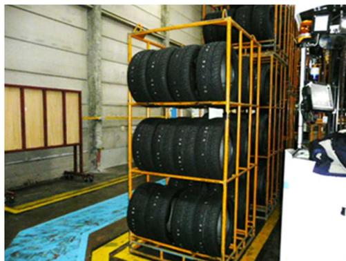
図4-5 既存（3段PCパレット）の架台
