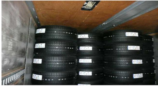
写真4-2：レース積み（タイヤを編み込むように積んでいく。一部の輸出向けの積載方法）
