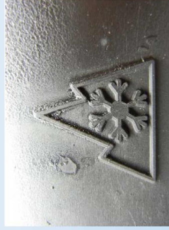
スノーフレークマーク タイヤの側面に表示 されています。
