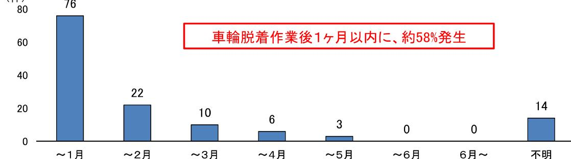
※車両総重量8トン以上の自動車又は乗車定員30人以上の自動車であって、車輪を取り付けるホイール・ボルトの折損又はホイール・ナットの脱落により車輪が自動車から脱落した事故
