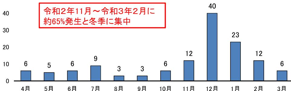
車輪脱着作業から車輪脱落事故発生までの期間別発生件数(令和2年度)
