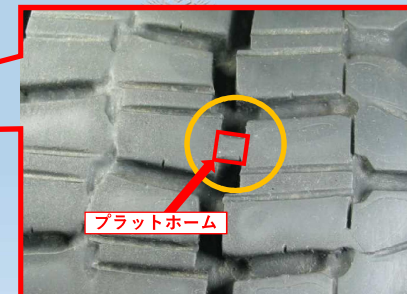
残り溝深さが「プラットホーム」に達している状態。冬用タイヤとして使用できません。
