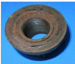
著しいさびや汚れによる ホイール・ナットとワッシャーの固着
