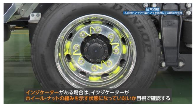
ホイール・ナットに緩みがないか、マーキング、インジケーターによる目視確認か、点検ハンマーによる確認を行います。
