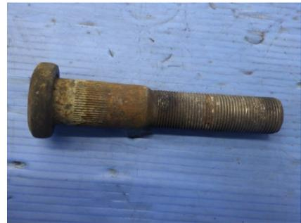
ホイール・ボルトのねじ部がディスク・ホイールとの干渉により損傷。また、油分が付着していなかった。
