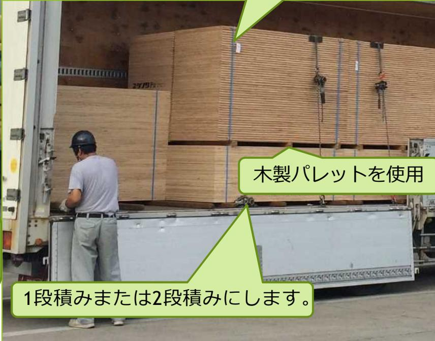
荷崩れ防止のため、ベルトで固定します
