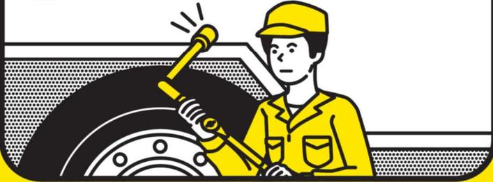
規定のトルクで確実な締め付けを
