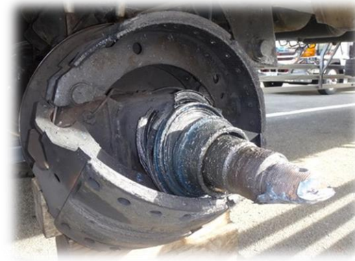
④ハブベアリングの破損
