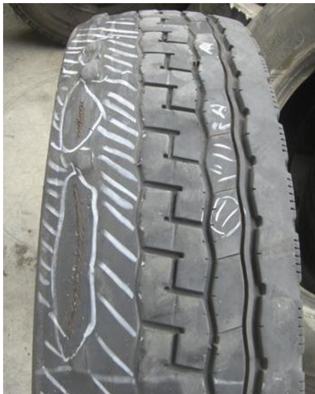
片減り摩耗 (ベルト露出)
