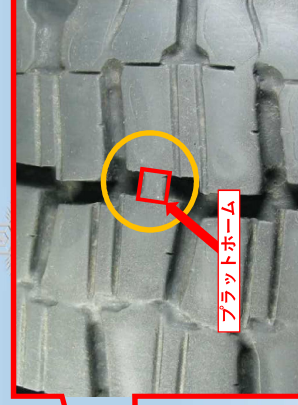
残り溝深さが「プラットホーム」に達している状態。冬用タイヤとして使用できません。
