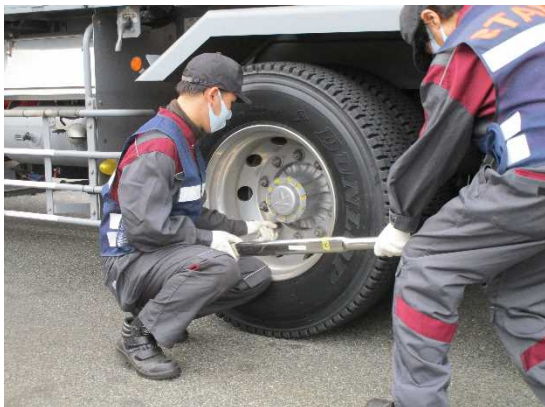
※大型車の車輪脱落の防止等を目的とした街頭点検の様相（令和2年度）
