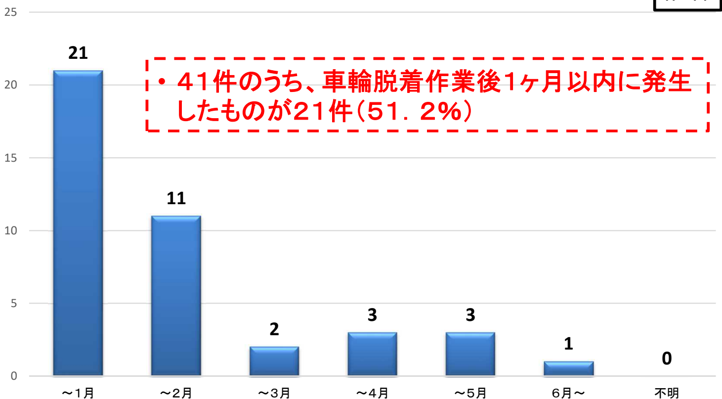
車輪脱着作業から事故発生までの期間別発生件数
