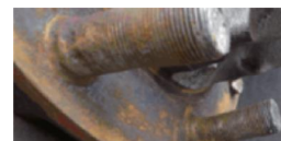
◀ホイールナットとワッシャーに変形が見られ、ワッシャーがはずれかかっている。
