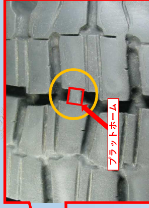
残り溝深さが「プラットホーム」に達している状態。冬用タイヤとして使用できません。
